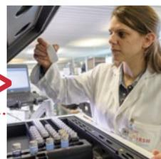
**7.2** Détection des rayonnements bêta (scintillation liquide)
