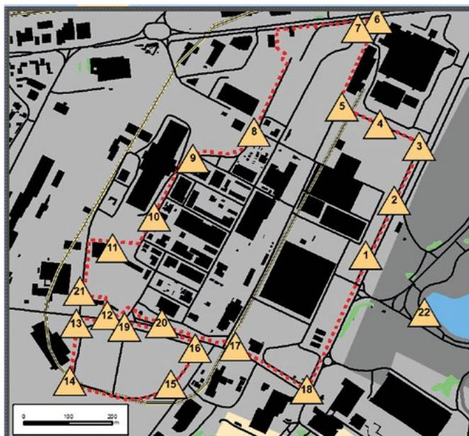
En février 2018, l'IRSN a réalisé des mesures de débit d'équivalent de dose dans la ville, à l'aide de deux spectromètres gamma embarqués dans un véhicule.
