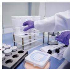
**6.** Radiochimie pour séparer et purifier les radionucléides à analyser
